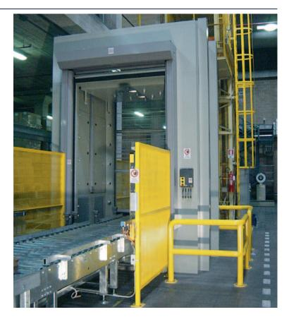
Le Docce d'aria della serie STORM sono macchine progettate per rimuovere le particelle inquinanti depositate sui pallets e sui materiali ad essi sovrastanti utilizzati in aree a contaminazione controllata od in tutti quei processi dove si renda necessario pulire i pallets e materiali prima delle operazioni di imballaggio e/o immagazzinamento.
